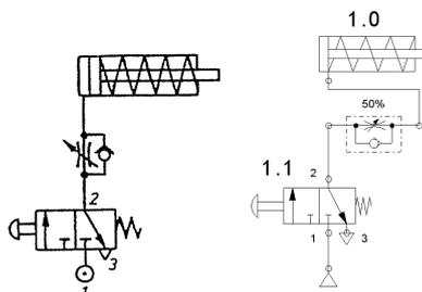
En el caso de los cilindros de simple efecto, solo se puede conseguir regular la velocidad de salida de su vástago, modificando la sección de paso del aire que alimenta la cámara de llenado del cilindro, instalando en ese conducto un paralelo formado por una válvula antirretorno, que imposibilite que el aire pase a su través en el momento del llenado de la cámara, pero permita su paso en el caso del vaciado de la cámara del cilindro, y una válvula reguladora de caudal.
