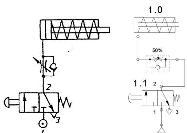
Debemos repetir la conexión del ejemplo anterior, pero en este caso se debe conectar la válvula antirretorno en la dirección contraria, para permitir el paso de aire que llene la cámara del cilindro y que imposibilite el paso del aire a su través durante el proceso de vaciado.
